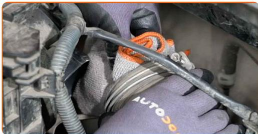
**9** Postavite ohišje zračnega filtra na stran.
