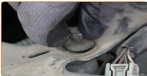
**12** Odstranite nosilec ohišja zračnega filtra.
