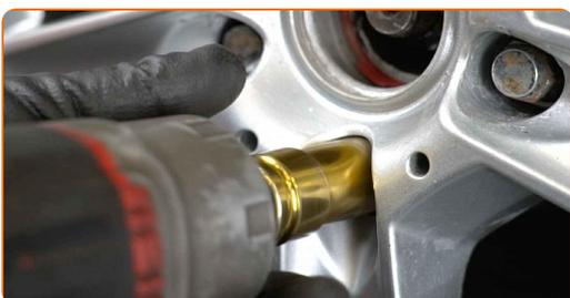
**22** Spustite avto in z delanjem v navzkrižnem vrstnem redu, zategnite kolesne vijake. Uporabite kolesni nasadni nastavek št. 19 Uporabite navorni ključ. Zategnite ga do navora 103 Nm.
