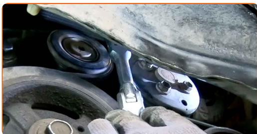
**15** Večkrat zavrtite ročično gred, da preverite, ali novi rebrasti jermen deluje pravilno. Uporabite nasadni ključ №19. Uporabite izvijač z zatikalom.
