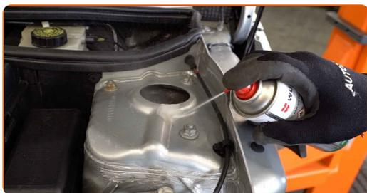
7 Očistite pritrdilne elemente opornikov stabilizatorja. Uporabite žično krtačo. Uporabite sprej WD-40.
