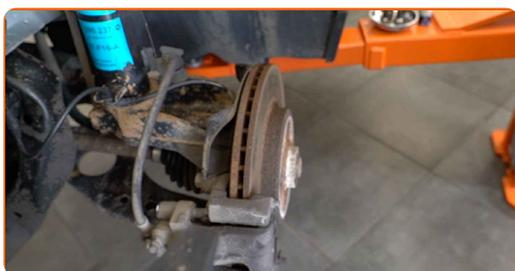
6 Odklopite kable in zavorno cev iz nosilca za amortizer.
