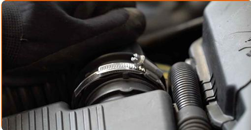
**11** Privijte pritrdilne vijke pokrova zračnega filtra. Uporabite nasadni ključ №8. Uporabite izvijač z zatikalom.
