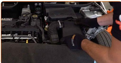
**10** Priključite cev za dovod zraka na ohišje zračnega filtra. Privijte objemko cevi filtra za gorivo. Uporabite nasadni ključ №6.
