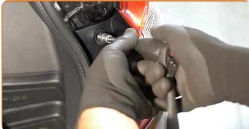
**9** Pričvrstite pritrdilni element, ki povezuje zadnjo luč s karoserijo. Uporabite nasadni ključ №10. Uporabite navorni ključ. Zategnite ga do navora 13 Nm.
