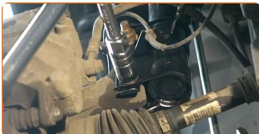
**62** Obdelajte pritrdilne elemente blažilnika. Obdelajte vse spoje opornika stabilizatorja. Uporabite bakreno mast.
