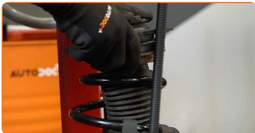
**42** Zategnite matico amortizerja. Uporabite imbus št. H6. Uporabite nasadni ključ №18. Uporabite navorni ključ. Zategnite ga do navora 62 Nm.
