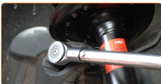
**61** Pritrdite spodnje pritrdilne elemente, ki povezujejo blažilnik in premnik. Uporabite nasadni ključ №21. Uporabite navorni ključ. Zategnite ga do navora 168 Nm.
