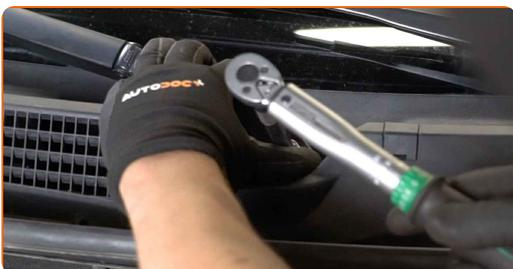
**76** Obdelajte pritrdilne elemente ročice brisalnika. Uporabite bakreno mast.
