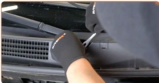
**4** Odvijte pritrdilni element metlic brisalcev vetrobranskega stekla. Uporabite nasadni ključ N°14. Uporabite izvijač z zatikalom.
