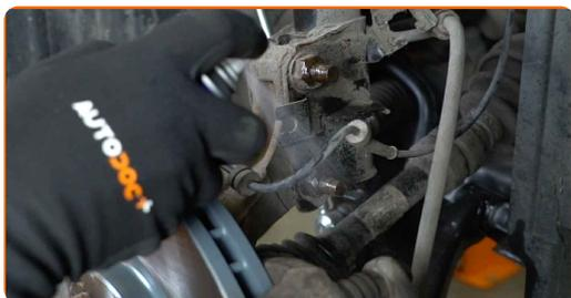
**23** Odvijte spodnji pritrdilni element, ki povezuje blažilnik s premnikom. Uporabite kombinirani ključ №18. Uporabite nasadni ključ №21. Uporabite izvijač z zatikalom.
