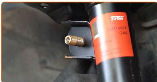
**60** Zategnite pritrdilni element, ki povezuje jarmov drog na blažilnik. Uporabite nasadni ključ №19. Uporabite navorni ključ. Zategnite ga do navora 65 Nm.
