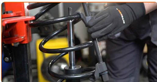
**41** Namestite nosilec, protiprašno zaščito in blažilec na nov amortizer.
