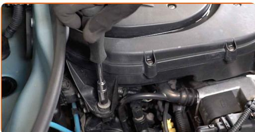
**4** Odstranite zadrževalno vzmet ohišja zračnega filtra.
