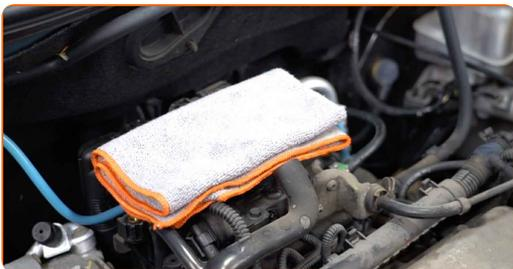
**7** Odstranite gibko cev bloka motorja iz pokrova motorja na levi. Uporabite lomilko.
