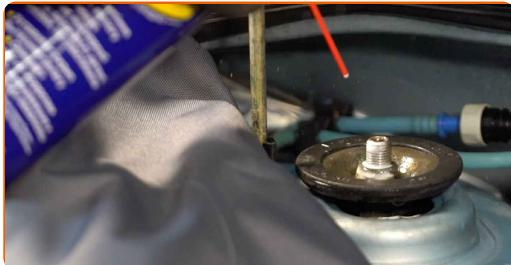
**4** Sprostite zgornji pritrdilni element sedeža za namestitev blažilnika. Uporabite imbus št. H6. Uporabite nasadni ključ N°19. Uporabite izvijač z zatikalom.
