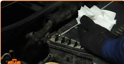
27 Preverite nivo olja 5 minut po prenehanju delovanja motorja tako da uporabite merilno palico in po potrebi dodate olje.
