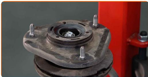
**31** Odstranite matico oporne batnice. Uporabite nasadni ključ №19. Uporabite izvijač z zatikalom.
