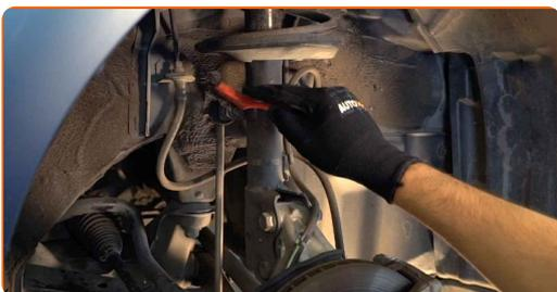
**18** Odklopite kable in zavorno cev iz nosilca za amortizer. Uporabite nasadni ključ №12. Uporabite izvijač z zatikalom.
