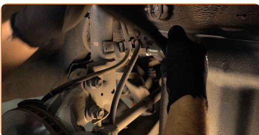
**19** Odvijte pritrdilni element, ki povezuje jarmov drog na blažilnik. Uporabite kombinirani ključ №17. Uporabite imbus št. H6. Uporabite izvijač z zatikalom.
