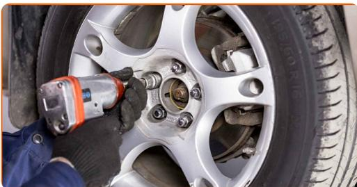
**34** Spustite avto in z delanjem v navzkrižnem vrstnem redu, zategnite kolesne vijake. Uporabite kolesni nasadni nastavek št. 21 Uporabite navorni ključ. Zategnite ga do navora 103 Nm.
