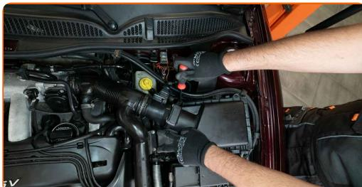
**4** Izključite konektor senzorja za masovni pretok zraka. Popustite objemko in odstranite zračno sesalno cev iz ohišja filtra. Uporabite kombinirane klešče.
