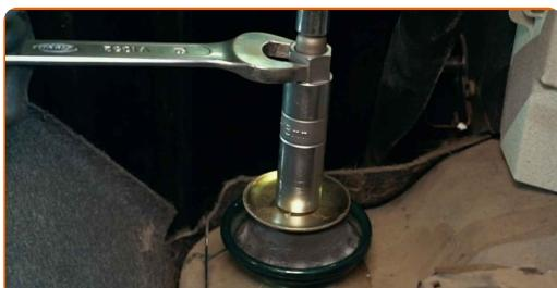
**11** Odvijte zgornji pritrdilni element vzmetne noge. Uporabite kombinirani ključ №17. Uporabite nasadni ključ za blažilnik DDNº5,2. Uporabite izvijač z zatikalom.
