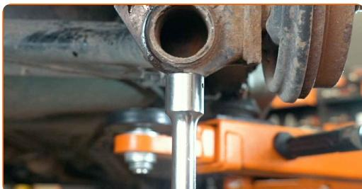
**45** Zategnite spodnje pritrdilne elemente vzmetne noge. Uporabite kombinirani ključ №17. Uporabite nasadni ključ №17. Uporabite navorni ključ. Zategnite ga do navora 55 Nm.
