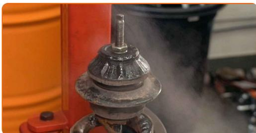
26 Odstranite matico oporne batnice. Uporabite kombinirani ključ №17. Uporabite nasadni ključ za blažilnik DDN№5,2. Uporabite izvijač z zatikalom.
