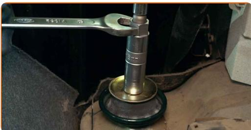
11 Odvijte zgornji pritrdilni element vzmetne noge. Uporabite kombinirani ključ №17. Uporabite nasadni ključ za blažilnik DDN№5,2. Uporabite izvijač z zatikalom.
