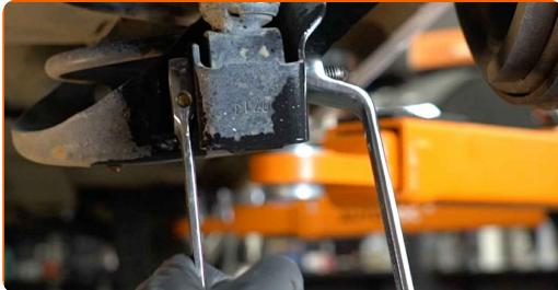
9 Podprite zadnji nosilec vzmetenja. Uporabite dvigalko s hidravličnim prenosom.
