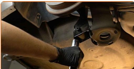
10 Odstranite pritrdilni vijak. Uporabite kombinirani ključ №16. Uporabite nasadni ključ №16. Uporabite izvijač z zatikalom.
