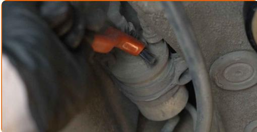
**6** Iz filtra za gorivo odklopite cevi za dovod goriva. Uporabite ploščat izvijač. Uporabite lomilko.
