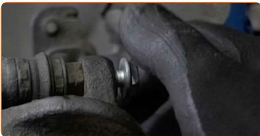
**20** Zategnite pritrdilne elemente zavorne čeljusti. Uporabite kombinirani ključ №13. Uporabite kombinirani ključ №15. Uporabite navorni ključ. Zategnite ga do navora 27 Nm.
