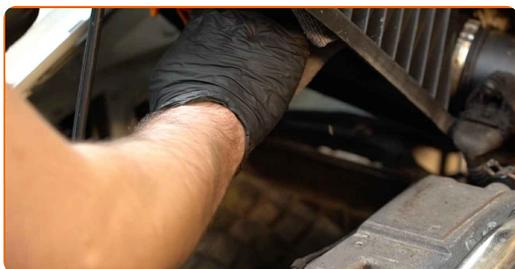
7 Očistite pokrov zračnega filtra in ohišje.
