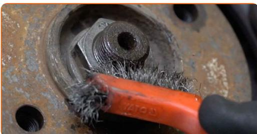
**19** Odvijte vijak osi pesta kolesa. Uporabite nasadni ključ №36. Uporabite izvijač z zatikalom.
