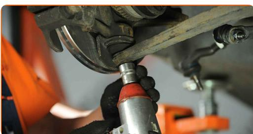
**16** Odklopite krogllični sklep s prečnega vodila. Uporabite snemalec nosilnega zgiba. Uporabite lomilko.
