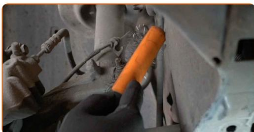
23 Odvijte spodnji pritrdilni element, ki povezuje blažilnik s premnikom. Uporabite nasadni ključ №16. Uporabite izvijač z zatikalom.
