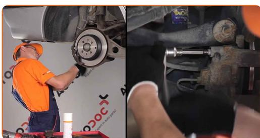
**27** Namestite pokrovčke manšete vodilnih zatičev zavornih čeljusti.
