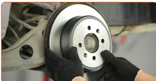
**20** Zategnite pritrdilne elemente zavornega koluta. Uporabite vijčni nastavek T30. Uporabite navorni ključ. Zategnite ga do navora 10 Nm.
