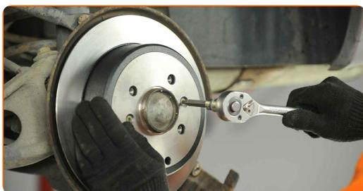
**21** Očistite pritrdilne elemente zavornih čeljusti. Uporabite žično krtačo. Uporabite sprej WD-40.
