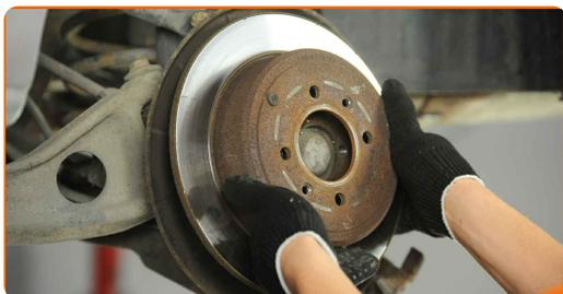
**18** Očistite pesto. Uporabite žično krtačo. Obdelajte kontaktno površino. Uporabite bakreno mast.
