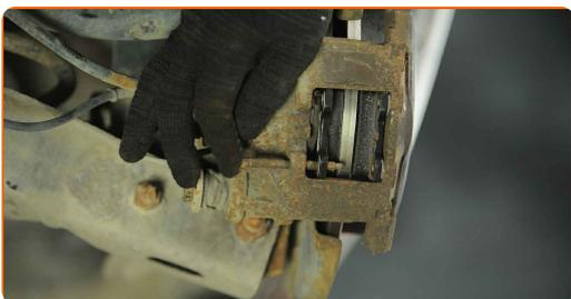
**30** Namestite zadrževalne vzmeti zavornih ploščic. Uporabite okrogle klešče.
