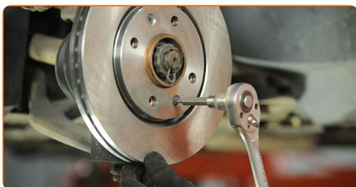
**25** Odstranite vodilne zatiče iz zavorne čeljusti.
