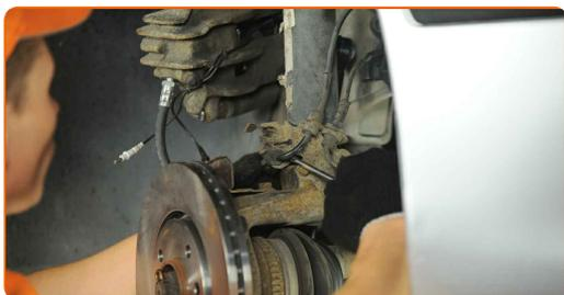
**14** Odvijte nosilec ABS kabla. Uporabite nasadni ključ №10. Uporabite izvijač z zatikalom.
