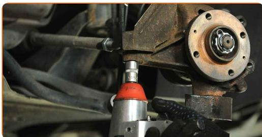
**64** Namestite nosilec na opornik amortizerja.
