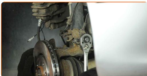
**15** Odstranite nosilec z opornika amortizerja.
