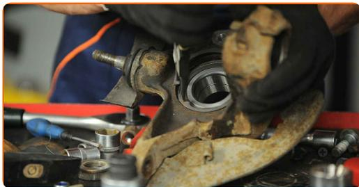
**44** Razstavite notranji obroč ležaja, ki je ostal na pestu. Uporabite komplet puše in ležaja gonilnika. Uporabite separator ležaja.
