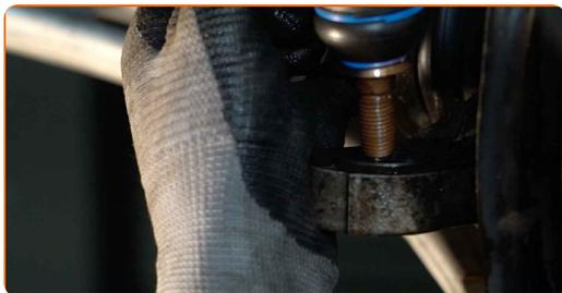
**63** Zategnite pritrdilno matico, ki povezuje glavo jarmovega droga s premnikom. Uporabite nasadni ključ №17. Uporabite navorni ključ. Zategnite ga do navora 35 Nm.
