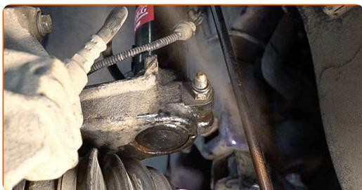
**78** Obdelajte površino, kjer se zavorni kolut stika s platiščem. Uporabite visokotemperaturno keramično pasto.
