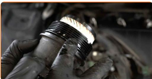
**19** Namestitev novega oljnega filtra pokrov ohišja in ga zategnite. Uporabite nasadni ključ №27. Uporabite navorni ključ. Zategnite ga do navora 25 Nm.
