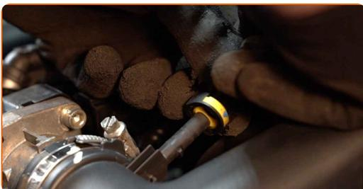
**4** Odvijte objemko, ki pritrjuje ohišje zračnega filtra motorja na nastavek dušilnih loput. Uporabite nasadni ključ №7.
