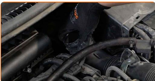
**4** Odstranite cev za dovod zraka.
