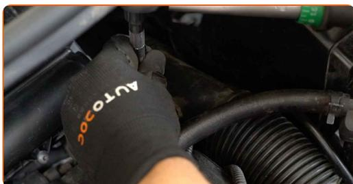
**65** Pustite da motor nekaj minut deluje. To je potrebno storiti zato, da odstranite odvečen zrak iz hladilnega sistema in da preverite, ali komponente delujejo pravilno.
