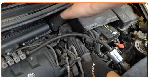
**64** Privijte pritrdilni element sesalne cevi. Uporabite nasadni ključ №10. Uporabite izvijač z zatikalom.
