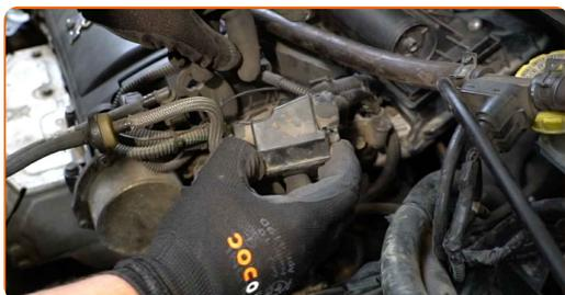
**12** Odstranite konektorje kabske napeljave motorja. Uporabite ploščat izvijač.
