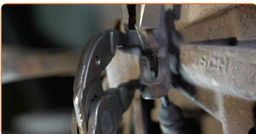
9 Očistite pritrdilne elemente zavornih čeljusti. Uporabite žično krtačo. Uporabite večnamenski čistilni sprej.
