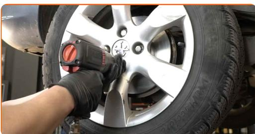
**33** Spustite avto in z delanjem v navzkrižnem vrstnem redu, zategnite kolesne vijake. Uporabite kolesni nasadni nastavek št. 17 Uporabite navorni ključ. Zategnite ga do navora 100 Nm.
