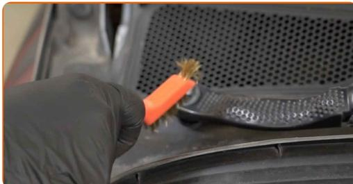
**4** Odvijte pritrdilni element metlic brisalcev vetrobranskega stekla. Uporabite nasadni ključ №16. Uporabite izvijač z zatikalom.
