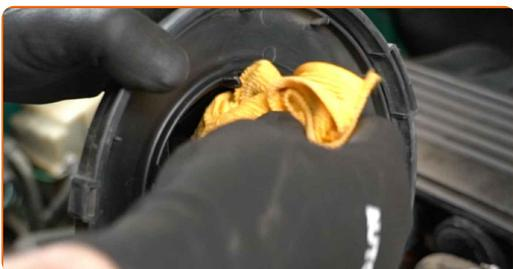
**12** Vstavite nov filtrirni element v ohišje filtra. Prepričajte se, da se robovi filtra tesno prilegajo ohišju.
