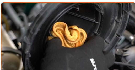
**10** Očistite pokrov zračnega filtra in ohišje.
