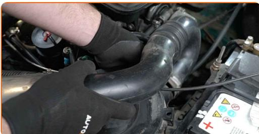
**16** Privijte pritrdilno objemko, ki povezuje zračni kanal z ohišjem zračnega filtra. Uporabite nasadni ključ №7. Uporabite izvijač z zatikalom.
