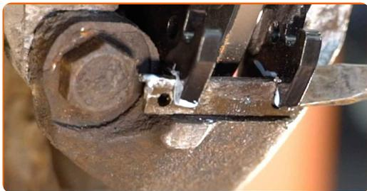
**15** Namestite zatič za fiksiranje zavorne ploščice.
