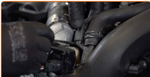
**3.2** Stisnite objemko s kombinirkami in odklopite cev vakuumskega ventila.
