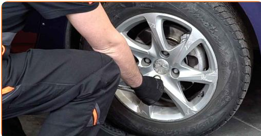
3 Sprostite pritrdilni element pogonske gredi. Uporabite nasadni ključ №32. Uporabite udarni nasadni ključ.
