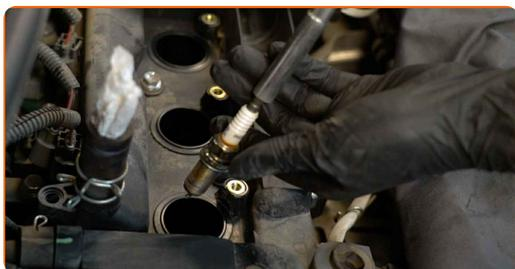
**14** Nanesite tanek sloj posebnega visokotemperaturnega maziva proti zatikanju na navoje novih vžigalnih svečk. Uporabite ploščat izvijač.
