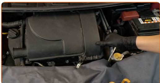
**25** Namestite pritrdilne objemke sesalne cevi zračnega filtra in dovodne cevi zračnega filtra. Uporabite klešče za objemke Clic-R.
