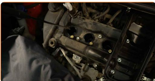
**12** Odvijte vžigalne svečke. Uporabite nastavek ključa za vžigalne svečke št. 16. Uporabite izvijač z zatikalom.
