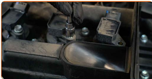
**19** Obdelajte konektor vžigalne tuljave s sprejem za elektroniko. Sprej bo zaščitil električne kontakte pred korozijo, oksidacijo in bo zmanjšal upor kontaktov.
