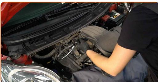
**6** Pokrijte nastavek dušilnih loput s krpo iz mikrovlaknen, da preprečite vdor prahu in umazanije v sistem.
