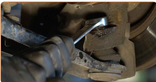
**11** Odklopite zglob od volanskega členek. Uporabite snemalec nosilnega zgiba.
