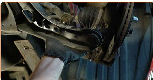
**13** Odvijte pritrdilni element, ki povezuje jarmov drog na palico stabilizatorja. Uporabite kombinirani ključ №10. Uporabite nasadni ključ №12. Uporabite izvijač z zatikalom.
