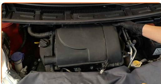
**13** Namestite pritrdilne objemke sesalne cevi zračnega filtra in dovodne cevi zračnega filtra. Uporabite klešče za objemke Clic-R.
