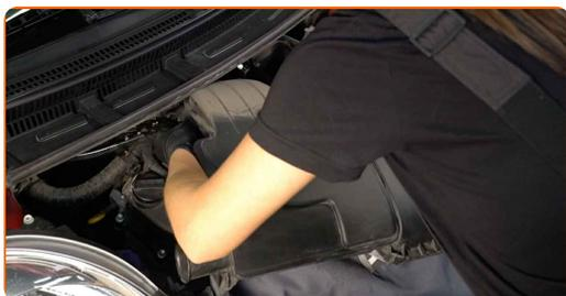
6 Pokrijte nastavek dušilnih loput s krpo iz mikrovlakn, da preprečite vdor prahu in umazanije v sistem.
