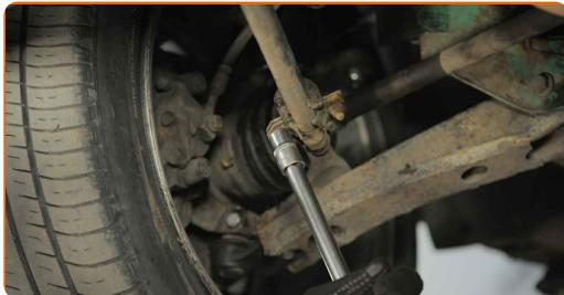
**4** Odstranite nosilce puš stabilizatorja.
