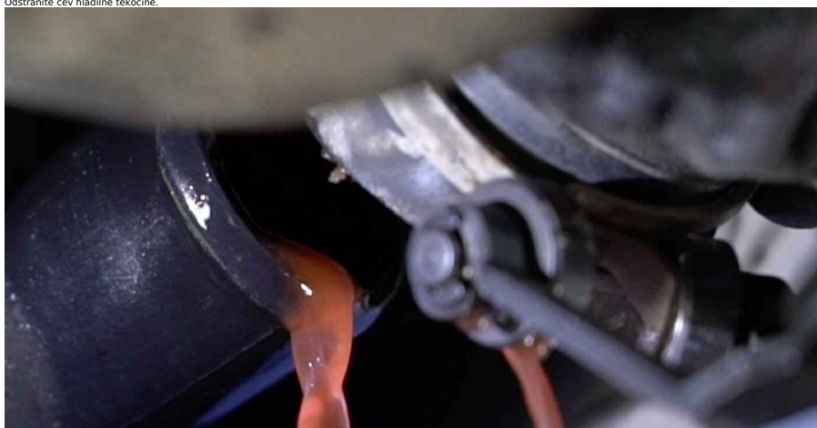
8 Odstranite cev hladilne tekočine.
