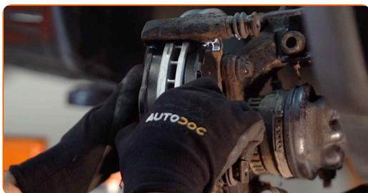
Menjava: zavornih ploščic – OPEL Corsa C Van (X01). AUTODOC priporoča:
