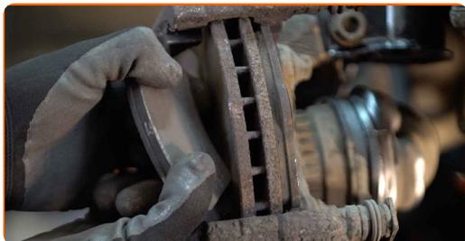
Menjava: zavornih ploščic – OPEL Corsa C Van (X01). AUTODOC nasvet:
