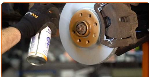
**Menjava: zavornih ploščic – OPEL Corsa C Van (X01). Nasvet:**
