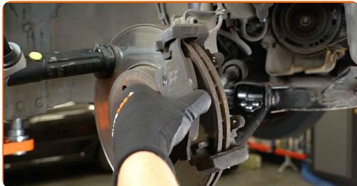
Menjava: zavornih ploščic – OPEL Corsa E Hatchback (X15). Strokovnjaki priporočajo:
