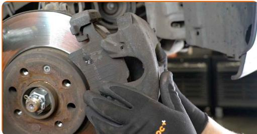
**Menjava: zavornih ploščic – OPEL Corsa E Hatchback (X15). Nasvet
