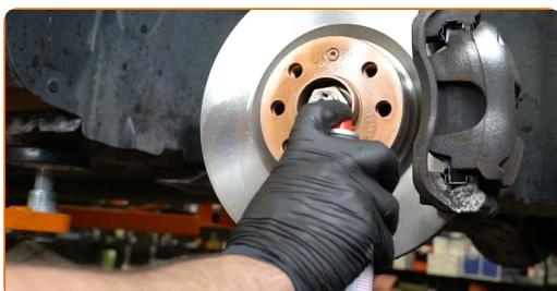
Menjava: zavornih diskov – OPEL Corsa D Van (S07). Nasvet:
