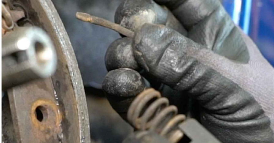
17 Snehite zavorno čeljust s spodnje vzmeti.
