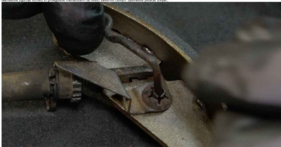
club.autodoc.si 11-18 36 Namestite novo desno zavorno čeljust.
