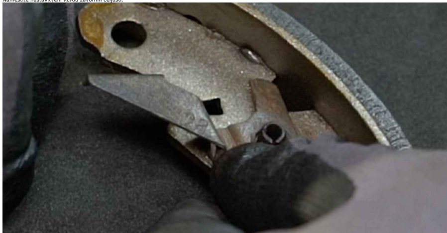
34 Namestite varovalni obroček.
