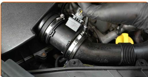
**6** Odstranite cev za dovod zraka.
