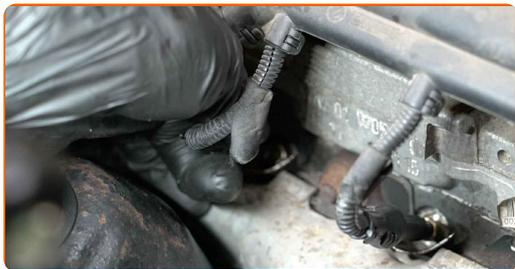
**9** Odvijte žarilne svečke. Uporabite nastavek ključa za vžigalne svečke št. 8. Uporabite izvijač z zatikalom.
