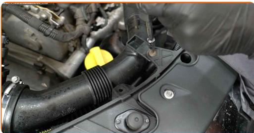
**5** Odstranite vpenjalni kos cevi za dovod zraka. Uporabite nasadni ključ №7. Uporabite izvijač z zatikalom.
