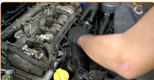
**7** Pokrijte cev za dovod zraka s krpo iz mikrovlakn, da preprečite vnos prahu in umazanije v sistem.
