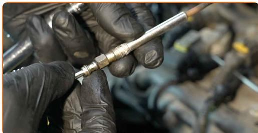
**11** Obdelajte žarilne svečke. Uporabite maščobo za injektorje in žarilne svečke.
