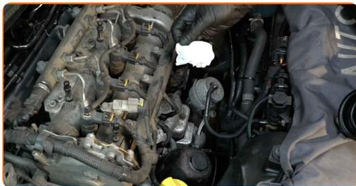
**16** Namestite cev za dovod zraka in jo pričvrstite.
