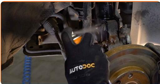
**36** Obdelajte površino, kjer se zavorni kolut stika s platiščem. Uporabite bakreno mast.
