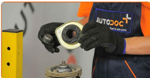
**22** Zategnite matico amortizerja. Uporabite ploščat izvijač. Uporabite nasadni ključ N°19. Uporabite navorni ključ. Zategnite ga do navora 55 Nm.
