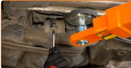
3 Stisnite sponke in odstranite cevi za dovod goriva iz ohišja filtra za gorivo. Uporabite klešče za cevi za gorivo.
