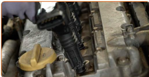
**8** Zategnite vijake vžigalne tuljave. Uporabite vijačni nastavek T30. Uporabite navorni ključ. Zategnite ga do navora 7 Nm.
