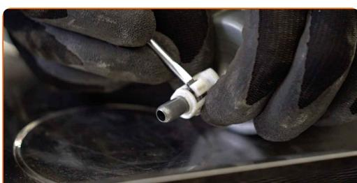
**8** Namestite fiksirno pločevino pritrtilnih elementov cevi filtra goriva.
