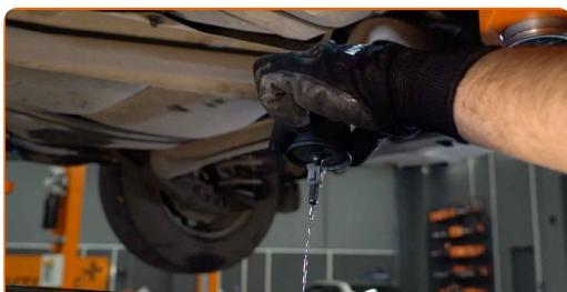
**7** Odstranite fiksirno pločevino pritrtilnih elementov iz cevi filtra goriva.
