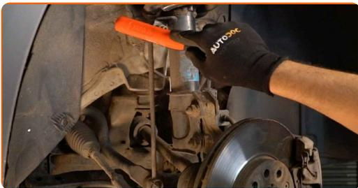
**14** Odvijte matico in odstranite drog stabilizatorja z opornika. Uporabite kombinirani ključ №19. Uporabite nasadni ključ №19. Uporabite izvijač z zatikalom.
