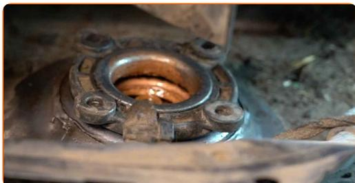
**49** Povežite pritrditev kabla ABS senzorja z opornikom amortizerja.
