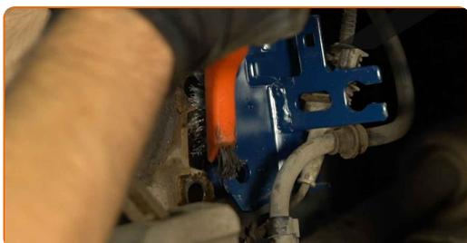
**45** Popravite opornik amortizerja na členku volana.
