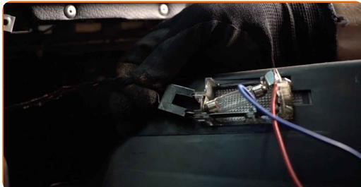
**6** Odstranite pritrdilne elemente, ki povezujejo cev za zrak in snop kablov na ohišje zračnega filtra.
