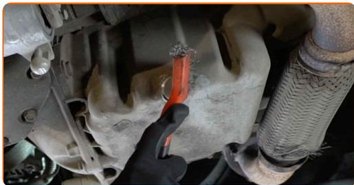
**7** Odvijte izpustni vijak. Uporabite vijačni nastavek T40. Uporabite izvijač z zatikalom.
