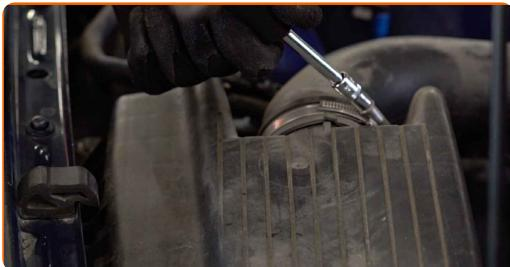
**4** Odklopite dovodno cev zraka z ohišja zračnega fitra.
